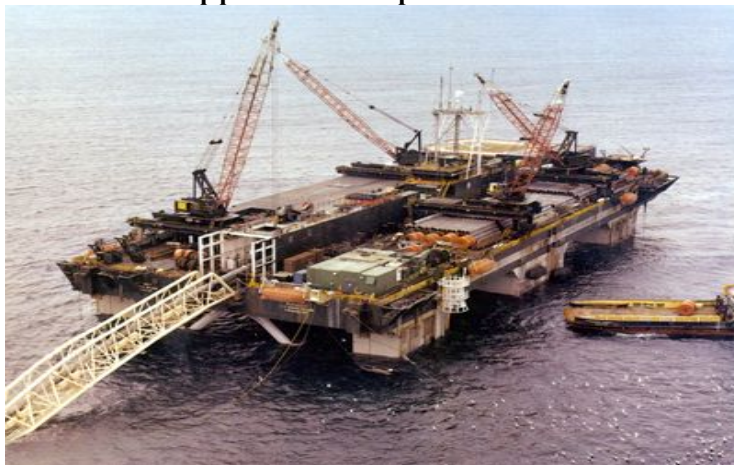
Рис. 7.1. Для установки подводных трубопроводов применяются различные типы барж
