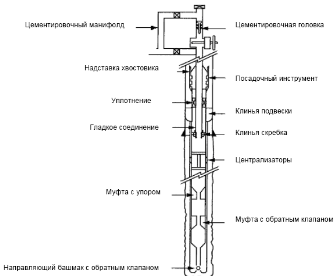
Рис. 9.5. Технология спуска хвостовика
