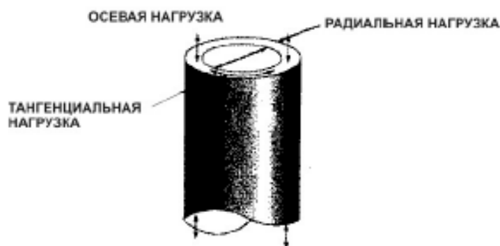
Рис. 9.9. Трехосная нагрузка на обсадную колонну
