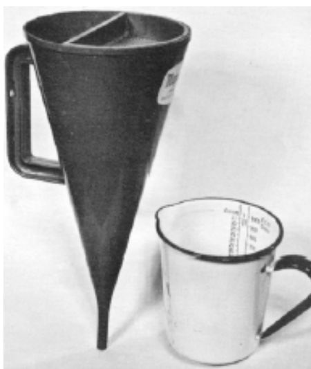
Рис. 6.10. Воронка МАРША для определения условной вязкости
