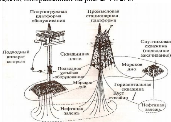
Рис. 2.4. Современные технические средства, используемые для разработки шельфовых месторождений
