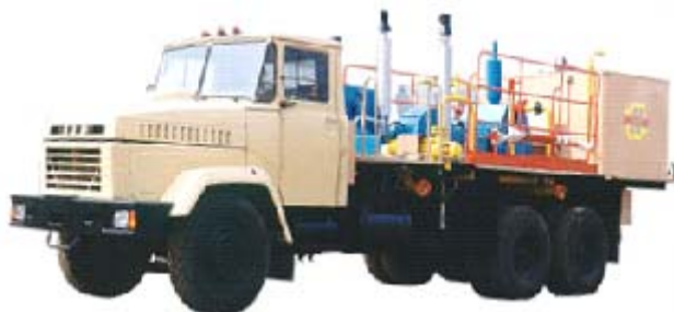
Рис. 10.5. Цементировочный агрегат ЦА-320
